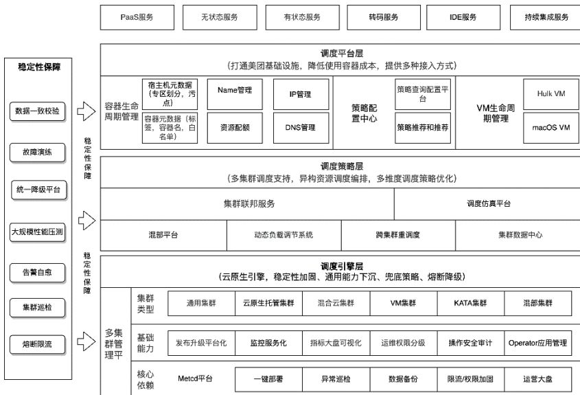
图2 美团集群调度系统架构图
